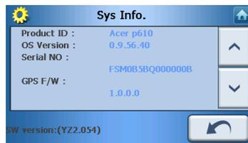
Aquí se puede ver la "Product ID" (Identificación de producto) de su dispositivo, el "Seria Number" (Número de serie), la "OS Version" (Versión del sistema operativo), la "GPS F/W" (Versión de firmware del GPS), la "PCB Version" (Versión del PCB), la dirección de Bluetooth MAC, la capacidad/utilizada del disco flash, la declaración del fabricante y de copyright, la marca comercial y el logotipo (© 2006 Acer Inc.)
