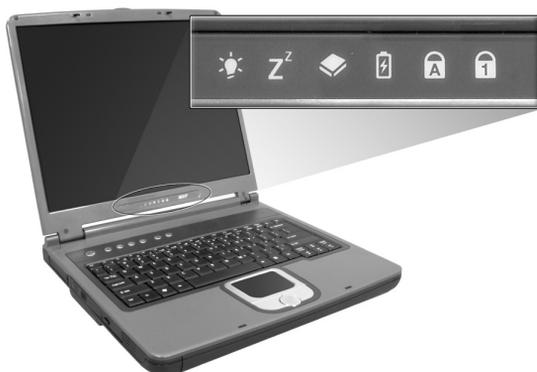
Le icone di stato relative alla modalità alimentazione (Power) e sospensione (Sleep) sono visibili anche quando il coperchio del display è chiuso, al fine di consentire il controllo continuo dello stato del computer.
