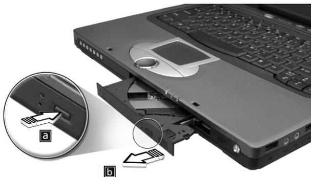
Com a energia desligada, pode-se ejetar o tabuleiro da unidade utilizando o furo de ejeção de emergência. Consulte página 54.
