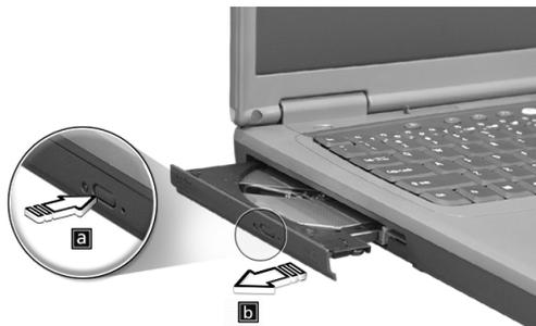
Quando a corrente está desligada, pode ejectar o tabuleiro da unidade utilizando o orifício de ejeção de emergência. Consultar página 53.
