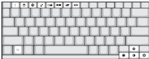
O computador utiliza teclas de aceleração ou combinações de teclas para ter acesso à maior parte dos comandos do computador como o contraste e a luminosidade do ecrã, a saída de som e o utilitário de configuração BIOS.
