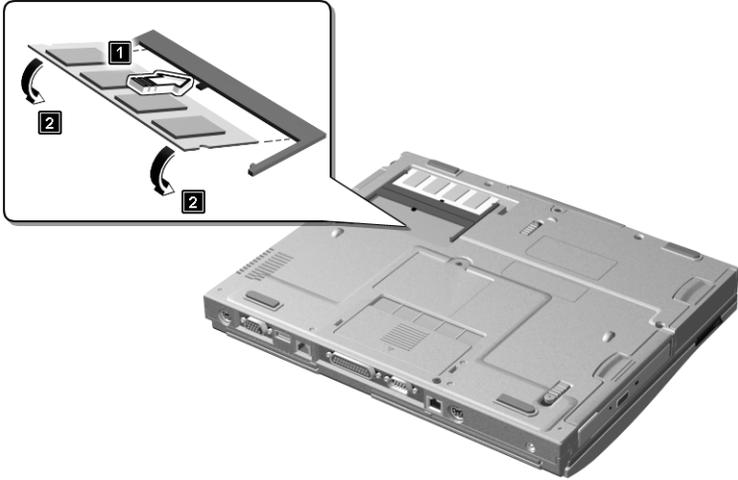
4. Substitua a tampa do compartimento da memória e fixe-a com os parafusos.
