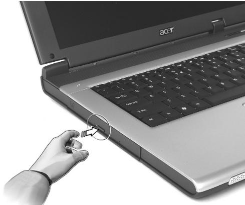
Wenn der Computer ausgeschaltet ist, können Sie den Laufwerksträger über das Notauswurfloch ausfahren.
