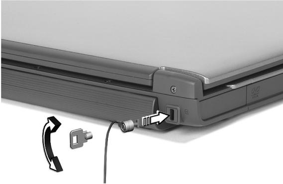
Binden Sie ein Diebstahlsicherungskabel an ein unbewegliches Objekt wie einen Tisch oder einen Griff einer abgeschlossenen Schublade. Stecken Sie das Schloß in den Anschluß für die Diebstahlsicherung, und schließen Sie dieses ab. Es gibt auch Modelle auch Schloß.
