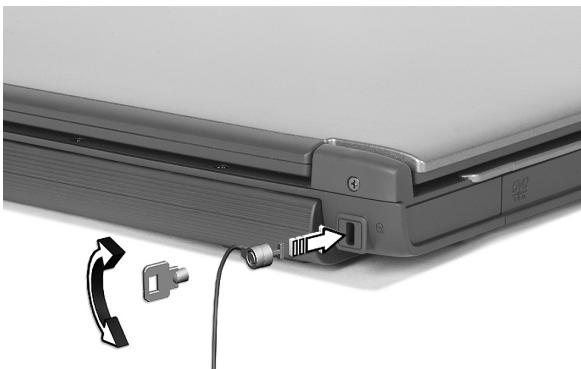
Pripojte kábel bezpečnostného zámku počítača k nepohyblivému predmetu, napríklad stolu alebo držadlu zaistenej zásuvky. Vložte zámok do otvoru a otočte kľúčom kvôli zaisteniu zámku. Niektoré modely sú dostupné aj bez zámku.
