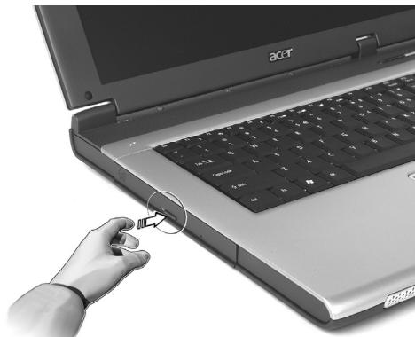
Ak chcete vysunúť optickú mechaniku na vypnutom počítači, použite otvor núdzového vysunutia.
