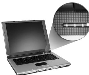
На передней панели есть еще два дополнительных индикатора. Определить состояние ноутбука или выполняемые им функции можно даже при закрытой крышке.
