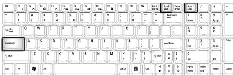
O computador possui três teclas de bloqueio, cada uma com sua luz de indicação de estado.
