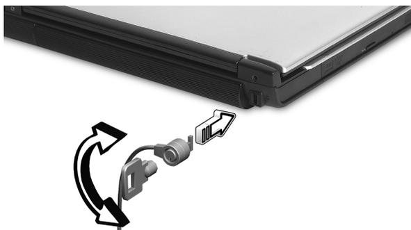
Обмотайте кабелем замка безопасности для компьютеров неподвижный предмет, например, стол или ручку запертого ящика. Вставьте замок в выемку и поверните ключ, чтобы запереть замок. Бывают и модели замков без ключей.
