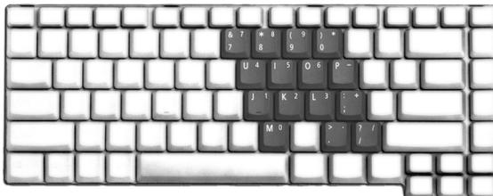
Функции встроенной числовой клавиатуры соответствуют функциям числовой клавиатуры рабочего стола. Они обозначены маленькими значками в верхнем правом углу клавиш. Чтобы упростить обозначения клавиатуры, символы клавиш для контроля курсора на клавишах не обозначены.
