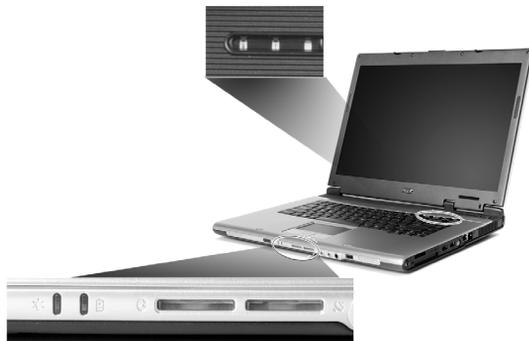
Индикаторы состояния "Питание", "Аккумулятор" и "Беспроводная связь" видны даже при закрытой крышке ЖК-дисплея.
