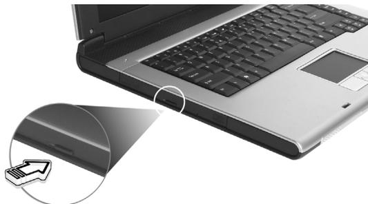
При отключенном питании лоток привода можно открыть, вставив тонкий стержень в отверстие аварийного извлечения.
