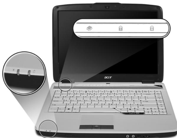
Индикаторы на передней панели видны даже при закрытой крышке компьютера.
