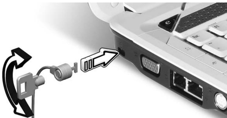
Avvolgere un cavo di sicurezza per computer intorno ad un oggetto fisso, ad esempio un tavolo o la maniglia di un cassetto chiuso a chiave. Inserire la serratura nel foro e girare la chiave per fissare il blocco. Sono disponibili anche modelli senza chiave.
