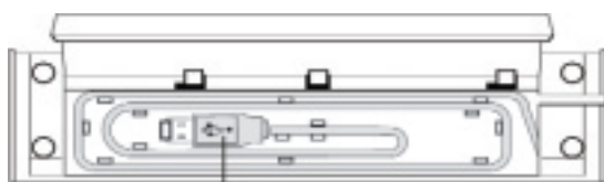
conector USB Parte inferior del duplicador de puertos con el compartimiento de cable abierto
