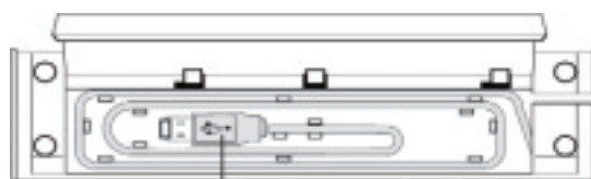
Connecteur USB Vue de dessous du réplicateur de ports montrant le compartiment du câble ouvert
