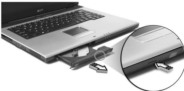
Wenn der Computer ausgeschaltet ist, können Sie den Laufwerksträger über das Notauswurfloch ausfahren. Siehe Seite 54.
