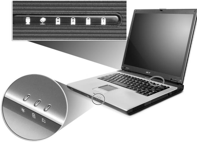
Die Batterie- und Stromversorgung Anzeigen sind zu sehen, wenn Sie die Anzeige schließen.
