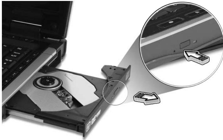
Τοποθετήστε ένα μεταλλικό συνδετήρα μέσα στην οπή έκτακτης εκτίναξης για εκτίναξη του συρταριού της μονάδας οπτικού δίσκου όταν ο υπολογιστής είναι απενεργοποιημένος.
