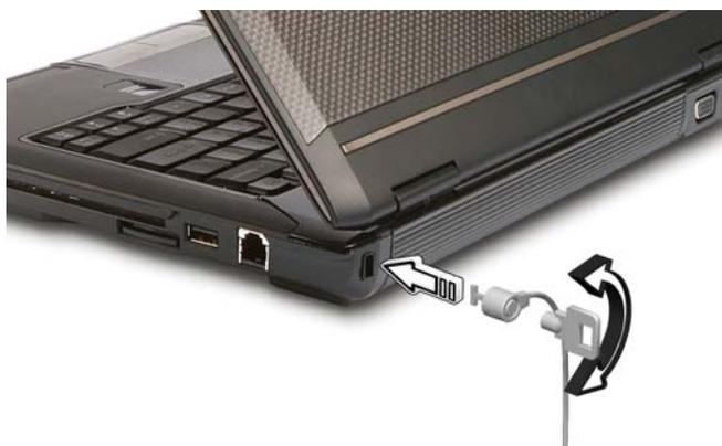
Avvolgere il cavo del blocco di sicurezza del computer attorno a un oggetto immobile, ad esempio una tavola o la maniglia di un cassetto chiuso. Inserire il blocco nella tacca e ruotare la chiave per chiudere il blocco. Sono disponibili anche modelli senza chiave.
