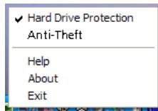
Η επιλογή αυτής της λειτουργίας έχει ως αποτέλεσμα τη στάθμευση των κεφαλών HDD σε περίπτωση ανίχνευσης τυχόν κραδασμού ή κίνησης καθ' υπέρβαση του ορίου ανοχής του HDD.
