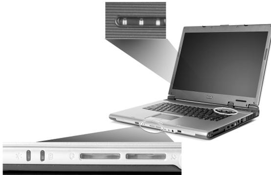
Die Statusanzeigen für Strom, Akku und Wireless-Kommunikation sind selbst dann zu sehen, wenn die LCD-Anzeige geschlossen ist.
