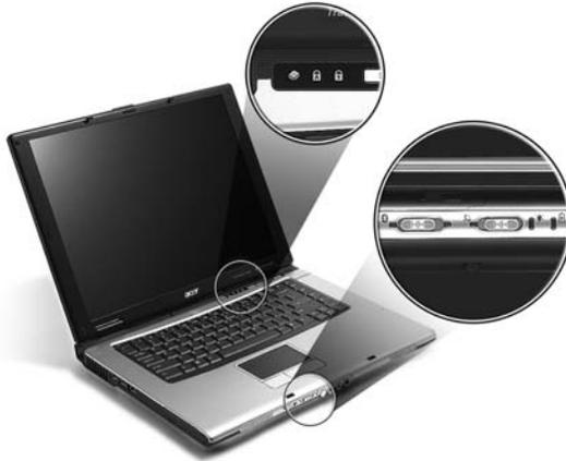
Los indicadores de estado de encendido/apagado batería y comunicación inalámbrica son visibles, aunque se cierre la pantalla LCD.
