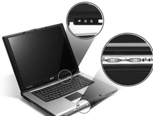
Индикаторы состояния "Питание", "Аккумулятор" и "Беспроводная связь" видны даже при закрытой крышке ЖК-дисплея.
