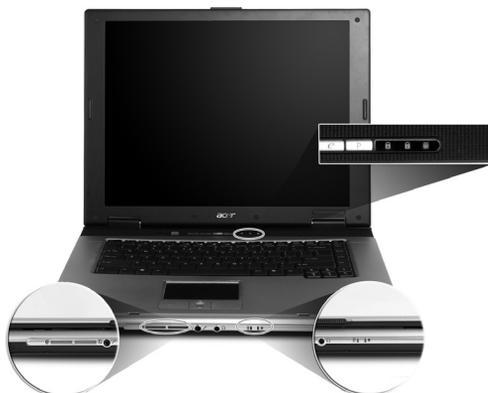
Os indicadores de estado Liga-desliga, Bateria e Comunicação sem fios podem ser vistos mesmo com o ecrã de cristal líquido fechado.
