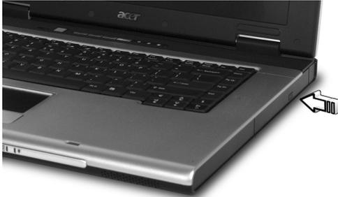
Com a energia desligada, pode-se ejectar o tabuleiro da unidade utilizando o furo de ejeção de emergência.
