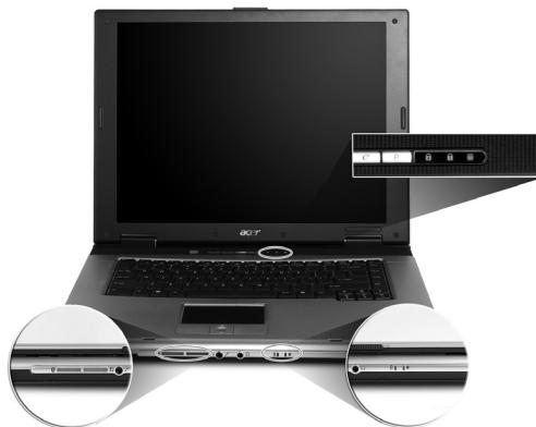
Индикаторы состояния "Питание", "Аккумулятор" и "Беспроводная связь" видны даже при закрытой крышки ЖК-дисплея.
