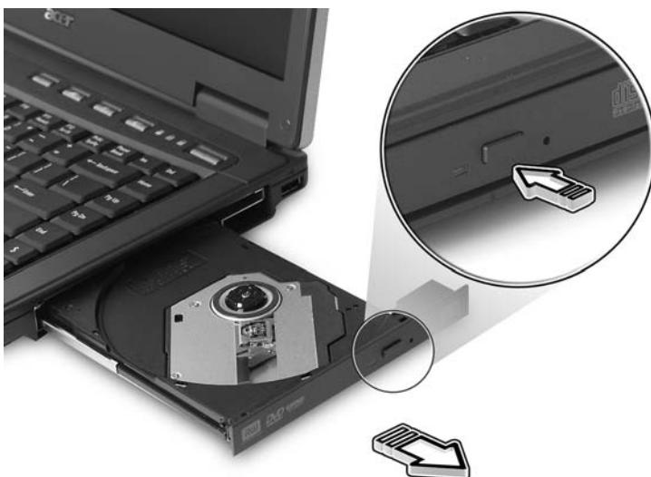
Na vypnutom počítači môžete optickú mechaniku vysunúť pomocou otvoru pohotovostného vysunutia.
