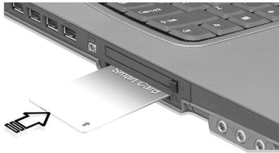
Para quitar la tarjeta Smart primero pulse la tarjeta Smart (a) y después quite la tarjeta (b) como se muestra en la ilustración más abajo.
