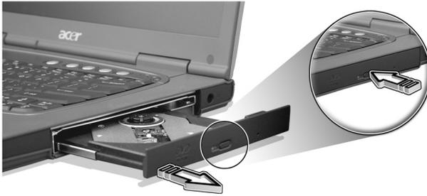
Wenn der Computer ausgeschaltet ist, können Sie den Laufwerksträger über das Notauswurfloch ausfahren. Siehe Seite 60.
