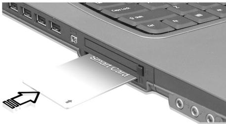
Drücken Sie zum Entfernen der SmartCard erst auf die SmartCard (a) und entfernen die SmartCard (b) dann wie in der Abbildung unten gezeigt.
