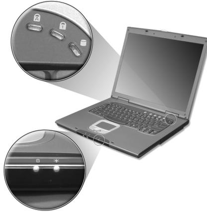
Die Batterie- und Ein-/Aus-Status Anzeigen sind zu sehen, wenn Sie die Anzeige schließen.
