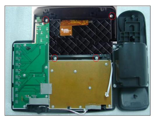
**Step6:** Replace a new LCD module.
